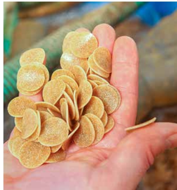
△ Auf den Chips im Biofilter siedeln Bakterien, die Nitrat im Wasser abbauen.
